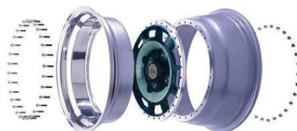
Abb.3: Aufbau einer dreiteiligen Felge
