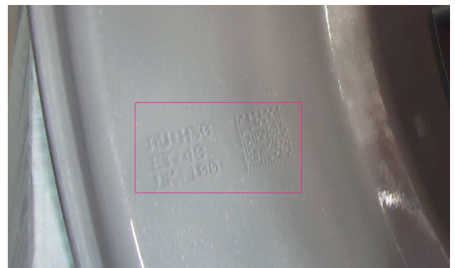
Abb.9: Technische Daten auf Felgenbett eingraviert
